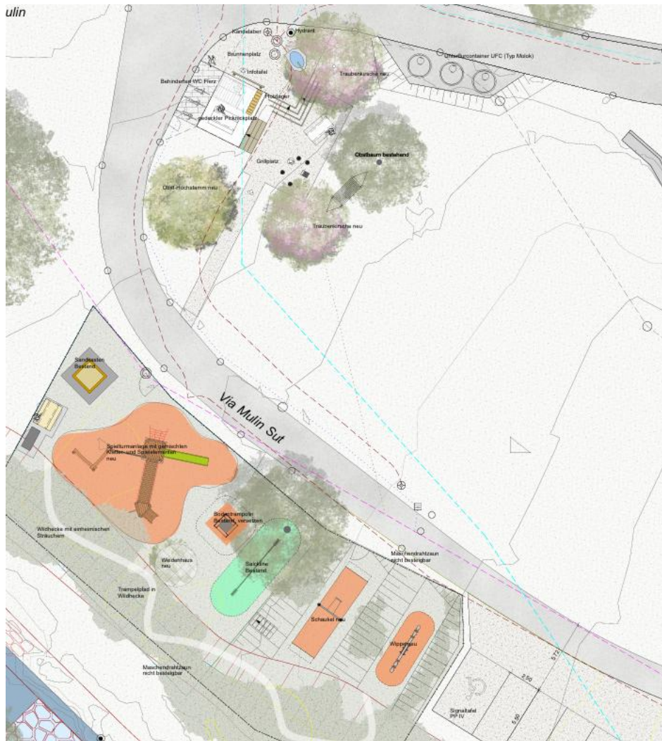
Abbildung 7: Plan des neu gestalteten Spielplatzes, welcher nach der Umsetzung der Massnahmen nicht mehr in der roten Gefahrenzone liegt und vom Damm geschützt wird. Dargestellter Massstab unbekannt.
